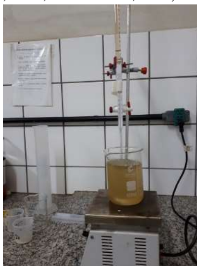
Figura 4. Processo de confecção dos filmes para as embalagens biodegradáveis. FONTE: Arquivo pessoal, (2019).
