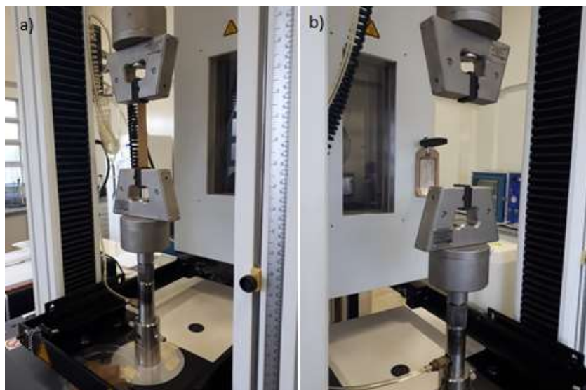
Figura 5. Análise mecânica em equipamento Instron, modelo 3367, Grove City. a) Análise do filme de pectina do mesocarpo do pequi; b) Análise do filme de pectina cítrica comercial. FONTE: Arquivo pessoal, (2019).
