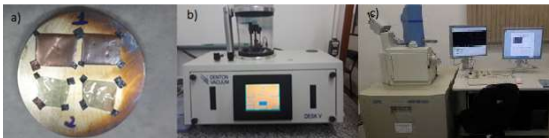
Figura 8. Análise de Microscopia Eletrônica de Varredura (MEV). a) preparo das amostras para cobertura de camada de ouro; b) Equipamento Denton Vacuum, Desk V. que realiza o recobrimento das amostras com camada de ouro. c) Microscópio Eletrônico de Varredura (Joel, JSM – 6619). FONTE: Arquivo pessoal, (2019).
